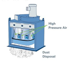
**FILTER CLEANING OPERATION** FOR CPV-1 MODEL
